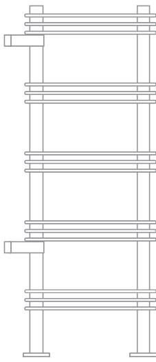
L'installazione a bandiera prevede allaccio speciale, apposito kit di fissaggio a parete composto da un kit di fissaggio composto ad staffe laterali + una coppia di piedini da terra. Tale supplemento va aggiunto al prezzo del radiatore in versione idraulica.
